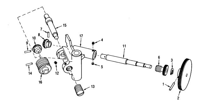
PRESS GEARS AND HANDWHEEL TIGHT AGAINST SHOULDER AND DRILL 0.078 + 0.004 HOLE TO ACCEPT SPRING PINS (1, 7, 9, AND 14) ADJUST SCREW (13) FOR 0.002 MAXIMUM WORM GEAR END PLAY BEFORE TIGHTENING SETSCREW (12).
